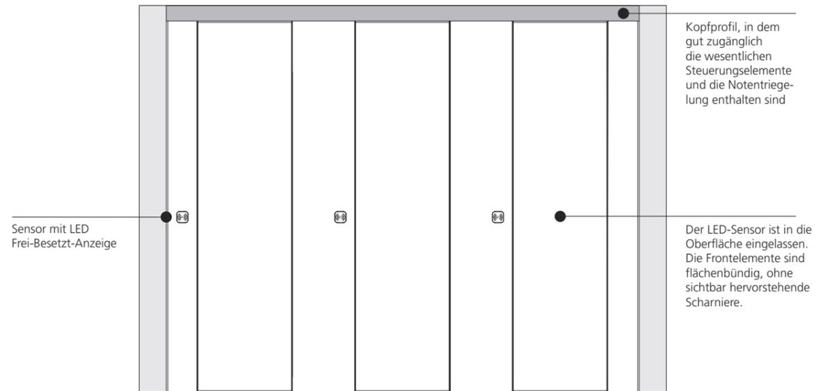
Stromzufuhr WC-Trennwand Typ EF-3 ALTUS mit Look&Wave Technologie
