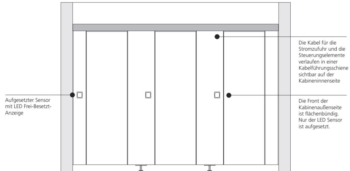
Stromzufuhr WC-Trennwand Typ SVF30 mit Look&Wave Technologie
