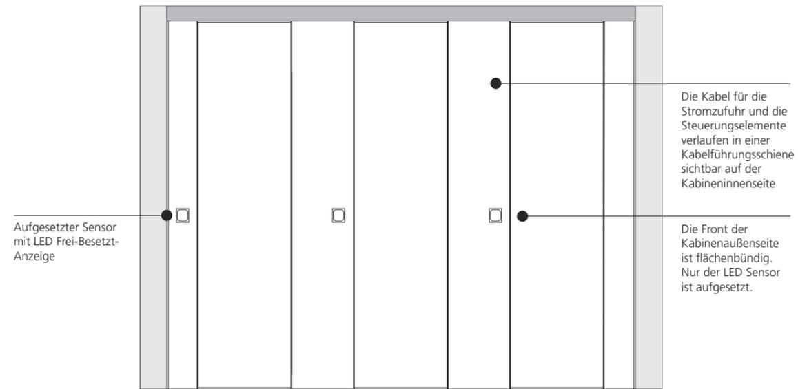
Stromzufuhr WC-Trennwand Typ SVF30/S ALTUS mit Look&Wave Technologie
