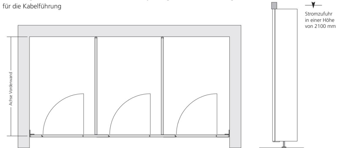
Höhenschnitt WC-Trennwand Typ EF-3 mit Look&Wave Technologie
