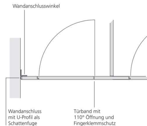
Aufgrund der schwebenden Optik ist eine stabile Befestigung der Wandanschlussteile der Front unbedingt erforderlich. Bitte beachten Sie dazu unsere speziellen technischen Hinweise.
