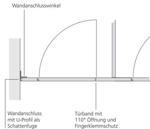
Aufgrund der Konstruktion ist eine stabile Befestigung der Wandanschlussteile der Front unbedingt erforderlich. Bitte beachten Sie dazu unsere speziellen technischen Hinweise.
